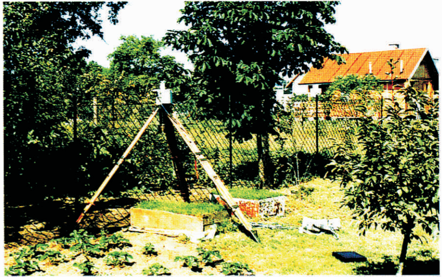
Ryc. 1. Zestaw doświadczalny do pomiarów spektrometrycznych Pb w trawach Fig. 1. Experimental set to spectral measurements of grasses with lead
