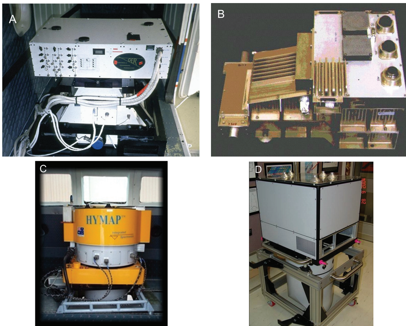
Ryc. 2. Hiperspektralne skanery lotnicze wykorzystywane przez DLR 4 : A – DAIS 7915, B – ROSIS, C – HyMap, D – ARES (źródło: Mueller, 2005)
