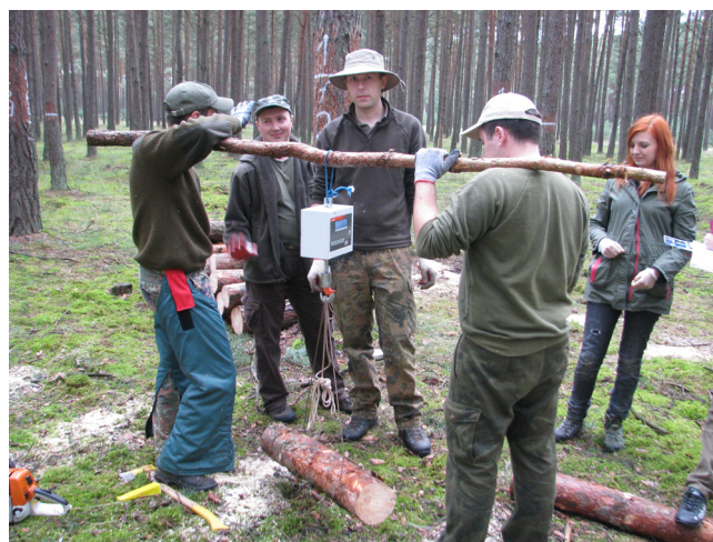
Ryc. 4. Jeden z etapów bezpośrednich pomiarów dendrometrycznych na ściętym drzewie. Określenie biomasy w stanie świeżym sekcji pnia (fot. A. Węgiel).
