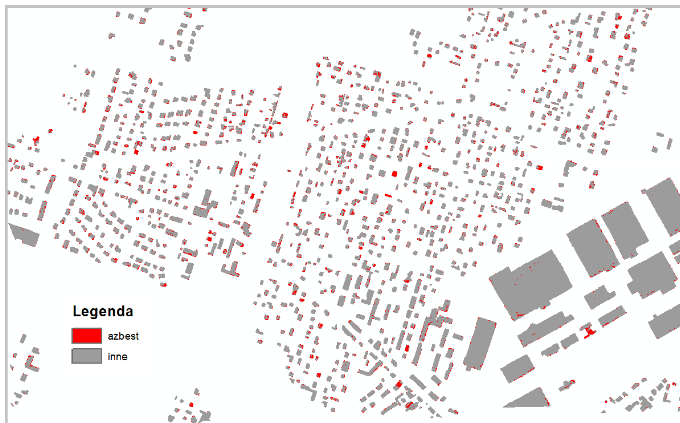
Ryc. 8. Wynik klasyfikacji nadzorowanej metodą maksymalnego podobieństwa po zastosowaniu filtracji MAJORITY 3x3 Fig. 8. The result of supervised classification by maximum similarity method using MAJORITY 3x3 filtering
