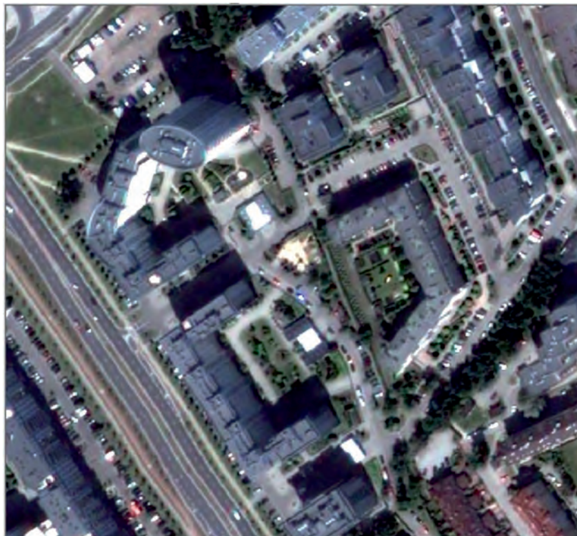
Ryc. 17. Widoczne na ortofotomapie odchylenie wysokich budynków, efekt braku korekcji tych obiektów (opr. własne)
